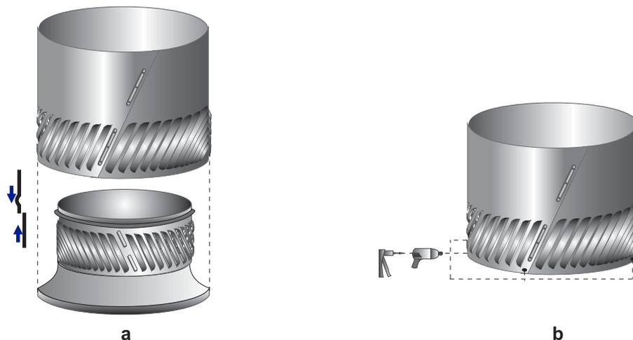
Encaixar a veneziana externa no conjunto interno (montado) (fig. 4a), furar e rebitar ambas (veneziana externa e conjunto interno) em 6 (seis) pontos equidistantes com broca 4mm (fig. 4b).
