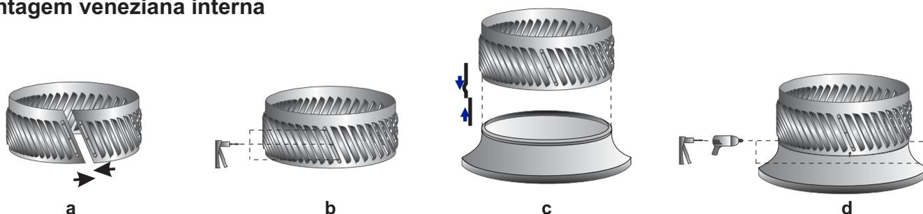
Sobrepor pelas cavidades das extremidades da veneziana interna (fig. 1a) e rebitar nos furos existentes (fig. 1b). Encaixar a veneziana interna no cone (fig. 1c). (as aberturas da veneziana deverá ficar inclinada para o lado esquerdo) Furar e rebitar a veneziana interna no cone (fig. 1d).
